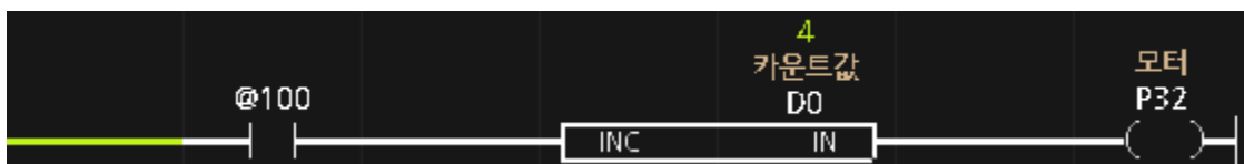
<1초에 한 스캔만 ON이 되는 특수비트메모리를 이용한 INC 평선블럭 실행>
